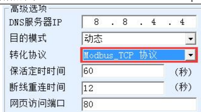
图 17 启用 Modbus TCP 功能
