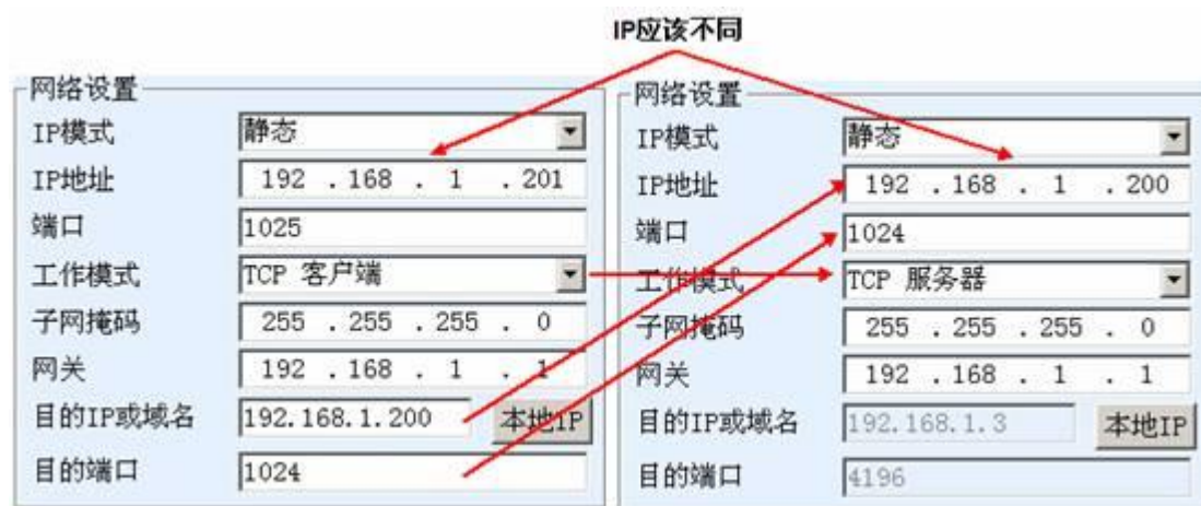
图 27 TCP 设备对联参数配置
