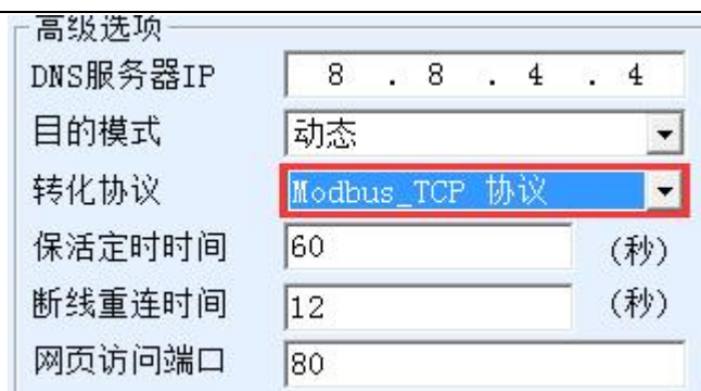
图 21 启用 Modbus TCP 功能
