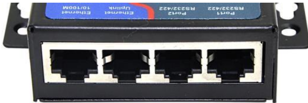
图 6 5200 的两路网口和两路 232
