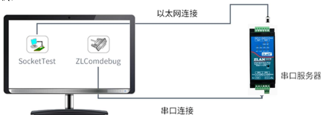
图 9 TCP 通讯示意图
