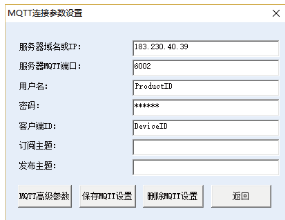
图.ZLVricom的MQTT参数和OneNet平台参数对应关系
