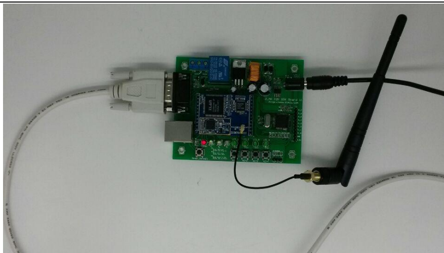
图 5 硬件连接图(Wifi 模块连入无线网)
